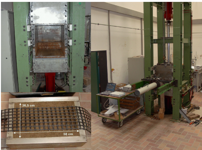
Bild 6: Großrahmenscherversuchsstand – Konfiguration für die Herauszieh- und Überlappungsversuche
