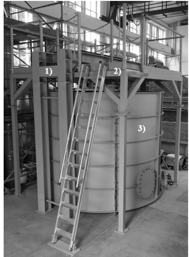
Abbildung 3-1: Pfahlprüfstand an der TU Bergakademie Freiberg. 1) Messbrücke, 2) Versuchsplattform, 3) Versuchsbehälter
