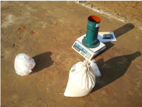
Bild 11: Beispiel für die Prüfung der Dichte mittels Sand-Ersatzmethode
