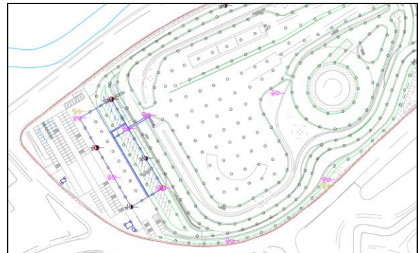
Bild 4: Beispiel eines Baugrundaufschlussplanes
